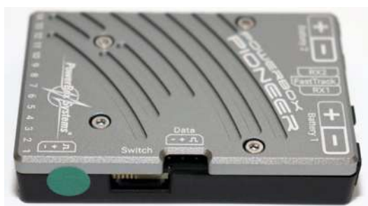
An der Seite wird der Ein-aus-Schalter angebracht. Am Data-Anschluss können das PowerBox-Interface oder ein BlueCom-Adapter angeschlossen werden
