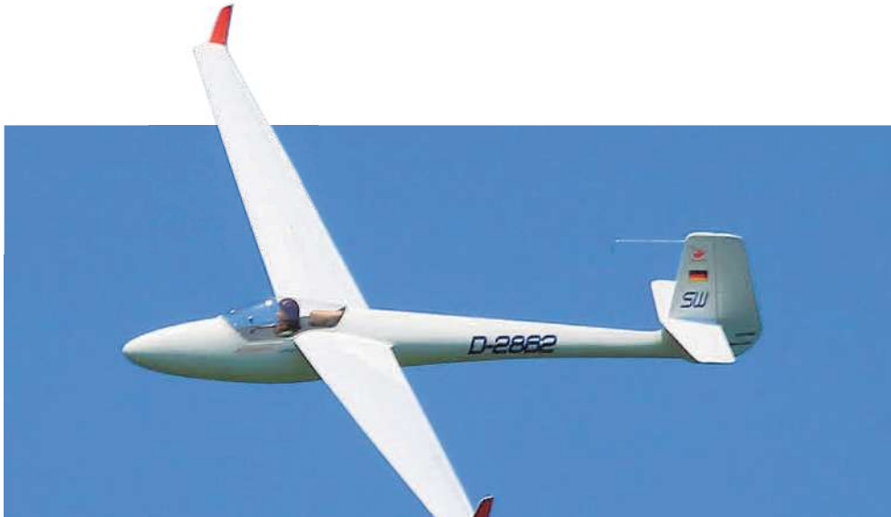
Die Libelle ist ein schönes und elegantes Segelflugzeug mit einem tollen Flugbild. Die TEK-Düse dient der Kompensation des Varios
