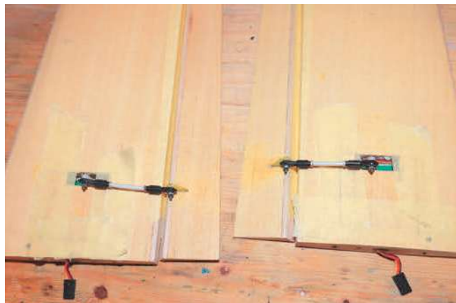
In jedem Höhenruder wurde ein KST-X10-Servo verbaut und mit Kugelköpfen angeschlossen
