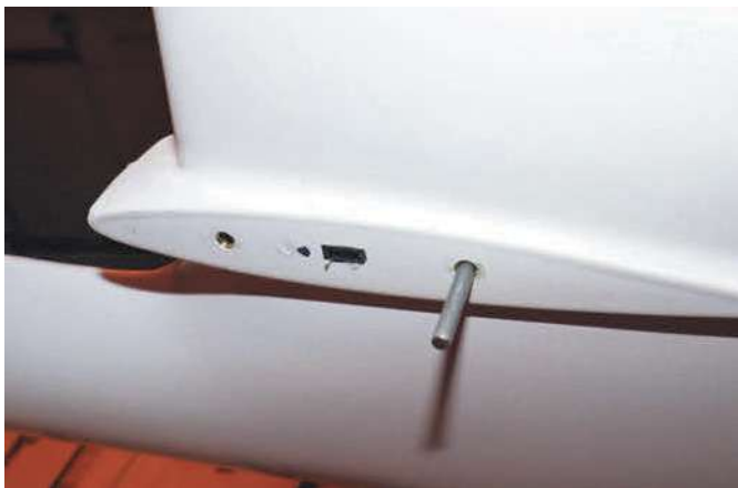
Um die Höhenruderservos anschließen zu können, wurden sowohl im Rumpf als auch im Ruder je ein JR-Stecker verklebt
