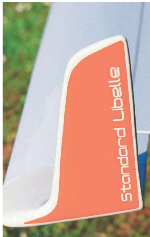
Die Winglets wurden mit 2K-Lack besprüht und mit passendem Foliendekor versehen
