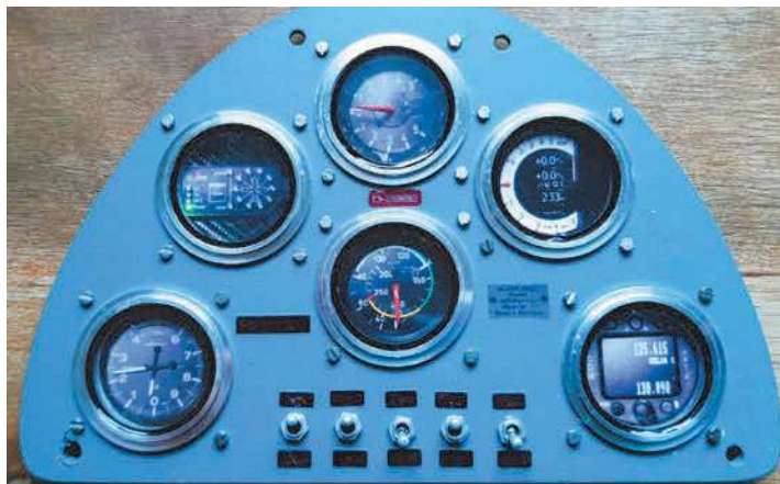
Das Instrumentenbrett ist in Anlehnung an das Original gestaltet worden. Die Instrumente wurden aus Alu-Drehteilen selbst hergestellt
