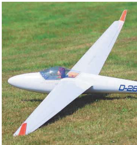
Die Winglets werden einfach angesteckt und mit weißem Isolierband gesichert
