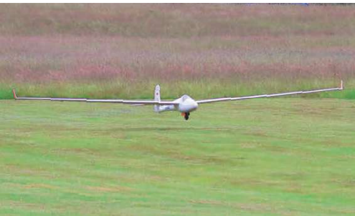
Im Bodeneffekt kann die Libelle H201b sehr schön lange gehalten und punktgenau gelandet werden
