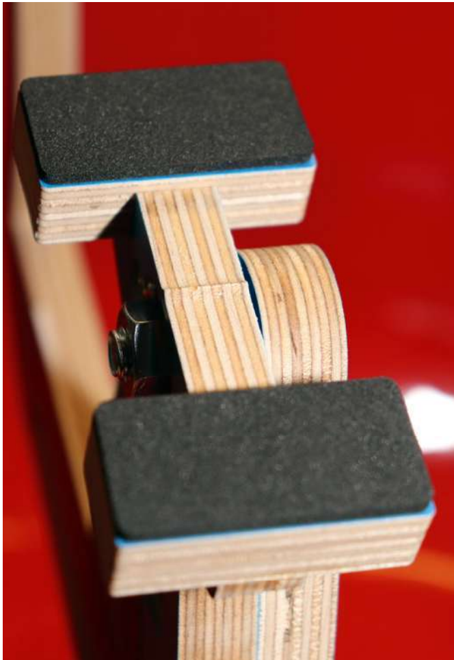
Mit den breiten Modellauflagen kann das Flugmodell sicher gehalten und professionell ausgewogen werden
