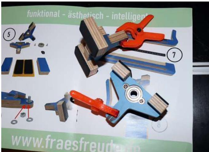
In den Modellaufgaben sind Kugellager verbaut, die sehr leichtgängig und spielfrei sind
